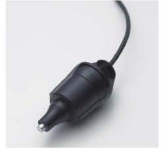
音波ではなく、磁力の変化をセンサで捕らえるので、スチールワイヤ・スチールベルトなどの測定が可能です。ゴムベルトでも雑音 (暗騒音) の影響を受けやすい環境下にて通常マイクで測定不可能な場合でも、薄い磁性体 (固有振動数に影響を及ぼさない程度) を塗布することで、測定可能になります。
